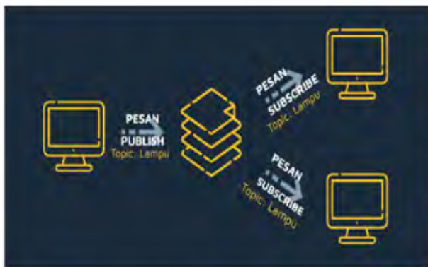
Proses kerja warning system Bendungan Pice
