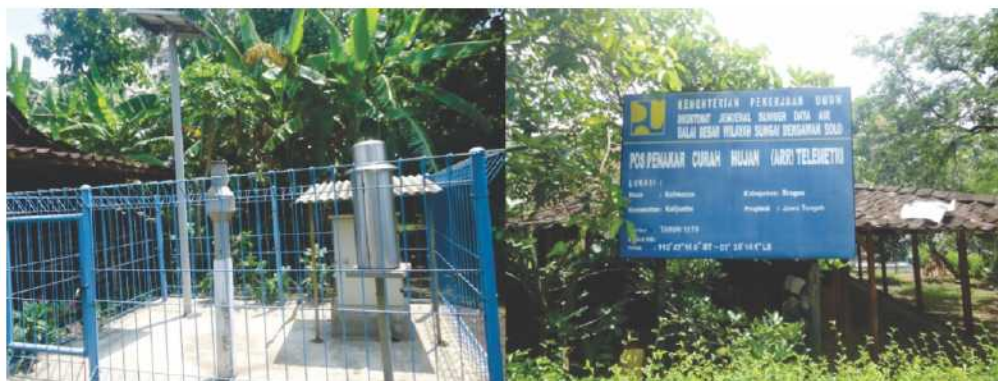
Gambar. Penakar hujan digital, Pos Penakar Hujan Telemetry Kalimacan Milik BBWS Bengawan Solo
