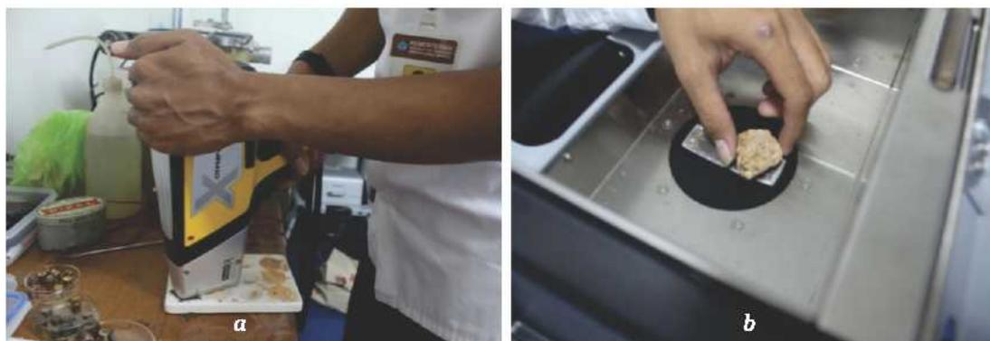
Gambar 5. a. Proses Kalibrasi dengan sampel standar; b. Pembacaan sampel dengan alat XRF
