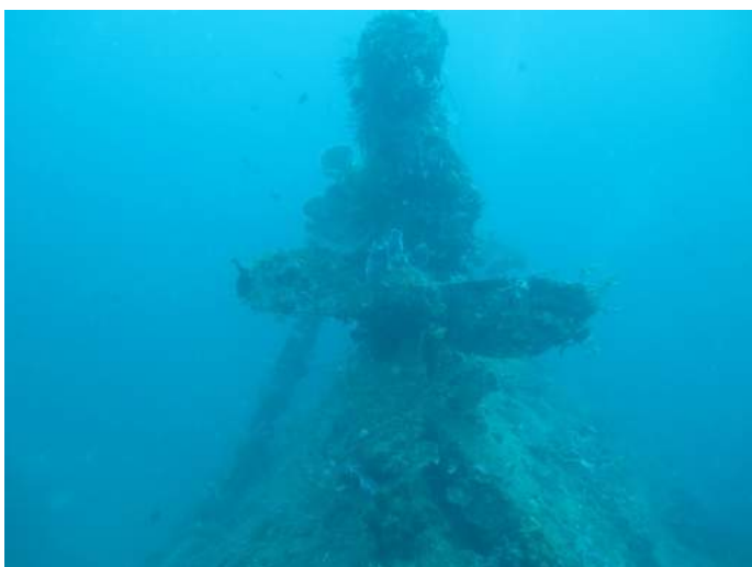
Posisi dan kondisi propeller (baling-baling) yang masih dilengkapi dengan propeller bracket , bulge keel dan stern tube . (Dok. BPCB Gorontalo 2015).
