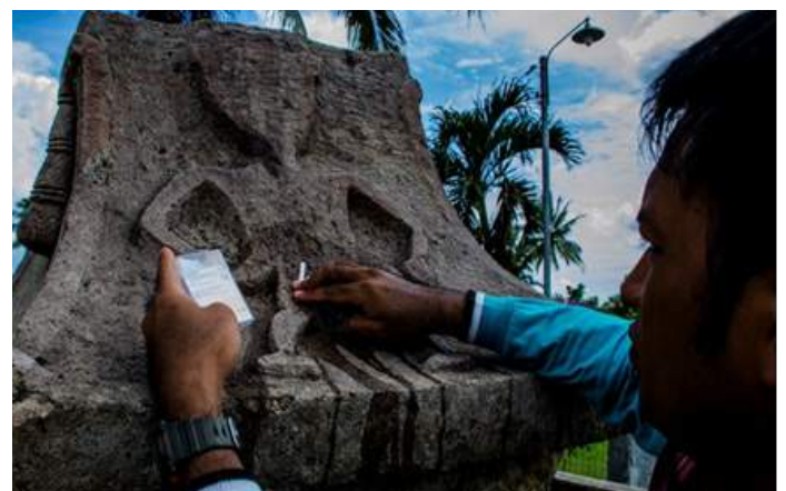
Foto 28. Pengukuran tingkat keasaman pasca konservasi pada keg konservasi waruga airmadidi (dok.bpcb gorontalo)
