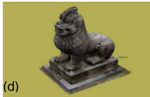
Gambar III.5. Hasil pemodelan 3D arca singa (a) tie points , (b) dense clouds , (c) mesh format , (d) tekstur
