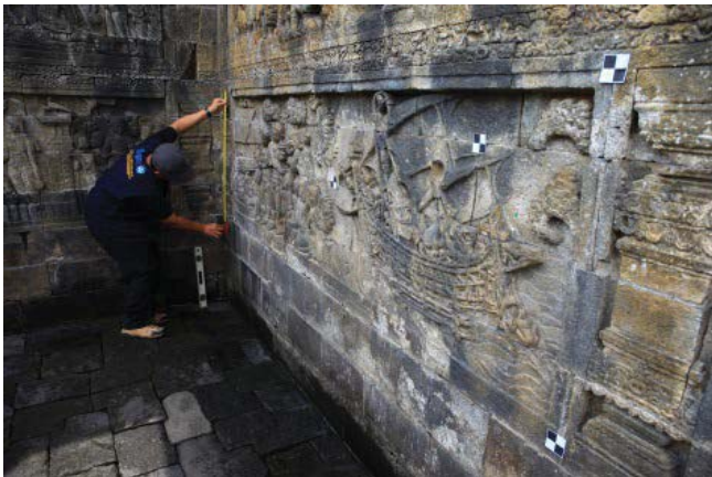
Gambar II.1. pengukuran titik kontrol relief dengan meteran
