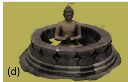
Gambar III.3. hasil pemodelan 3D stupa teras terbuka (a) tie points , (b) dense clouds , (c) mesh format , (d) tekstur
