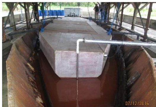
Kondisi terakhir perahu (sekoci sudah dipasang dan perahu direndam dengan larutan PEG 400).
