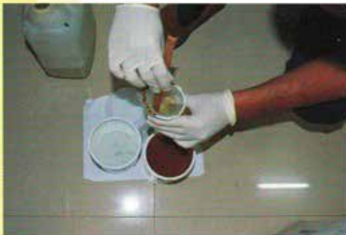
Gambar 8. Pencampuran bahan perekat dan larutan paraloid 2%
