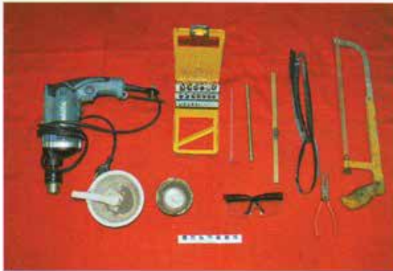
Gambar 16. Beberapa peralatan untuk penyambungan fosil dengan angkur kuningan
