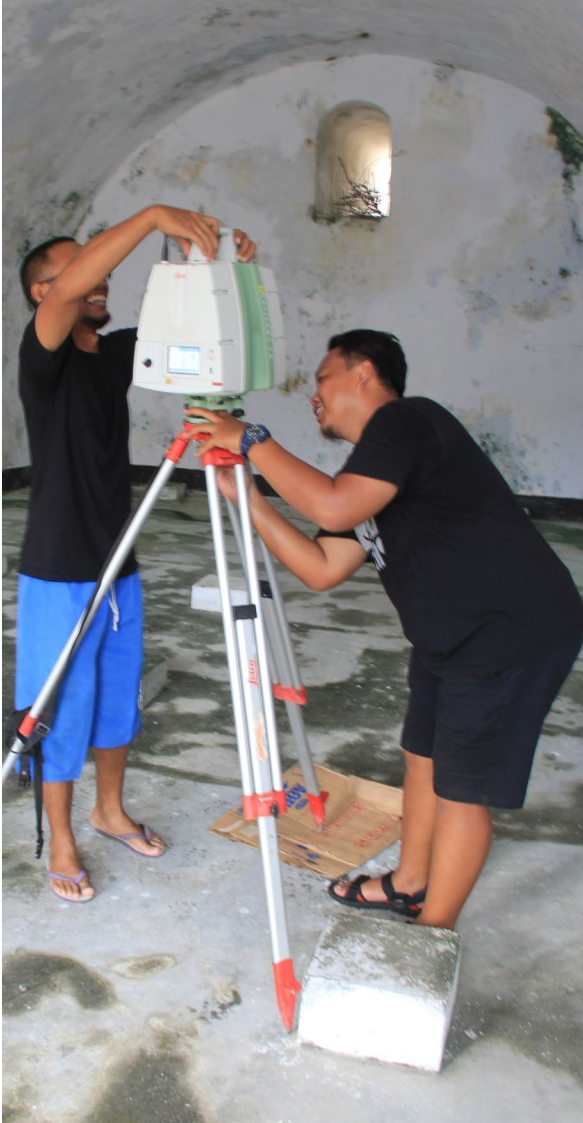
▲ Pemasangan alat 3D Scanner yang dilakukan di salah satu ruangan Benteng Belgica Sumber : Dok. BPCB Malut
