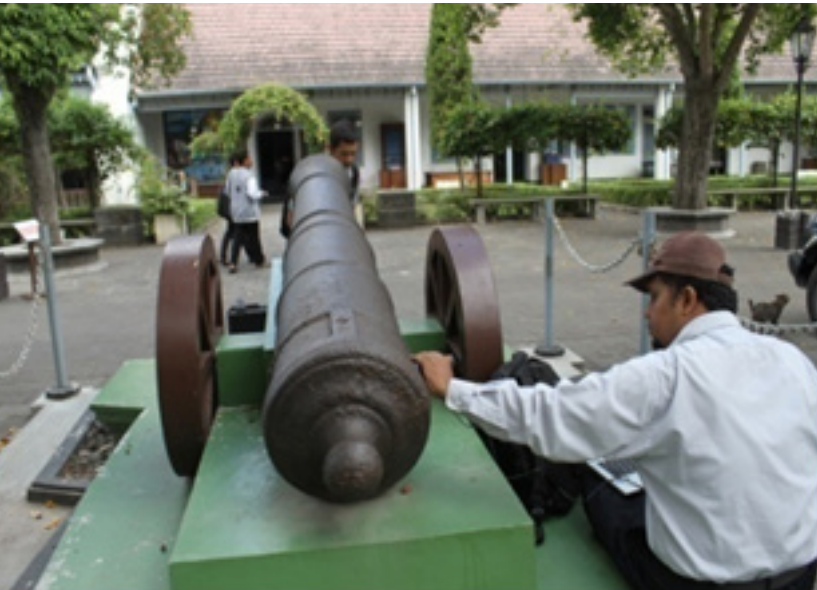
Gambar 1. Meriam di Museum Benteng Vredeburg yang Mengalami Korosi Pasif
