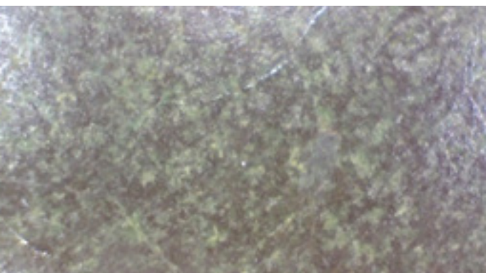
Gambar 2. Contoh Korosi Pasif pada Perunggu
