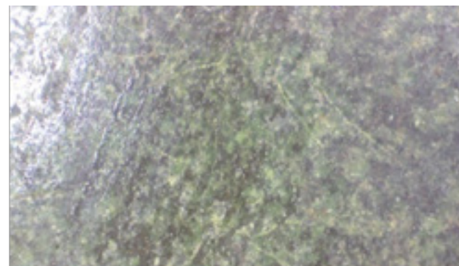
Gambar 2. Contoh Korosi Pasif pada Perunggu
